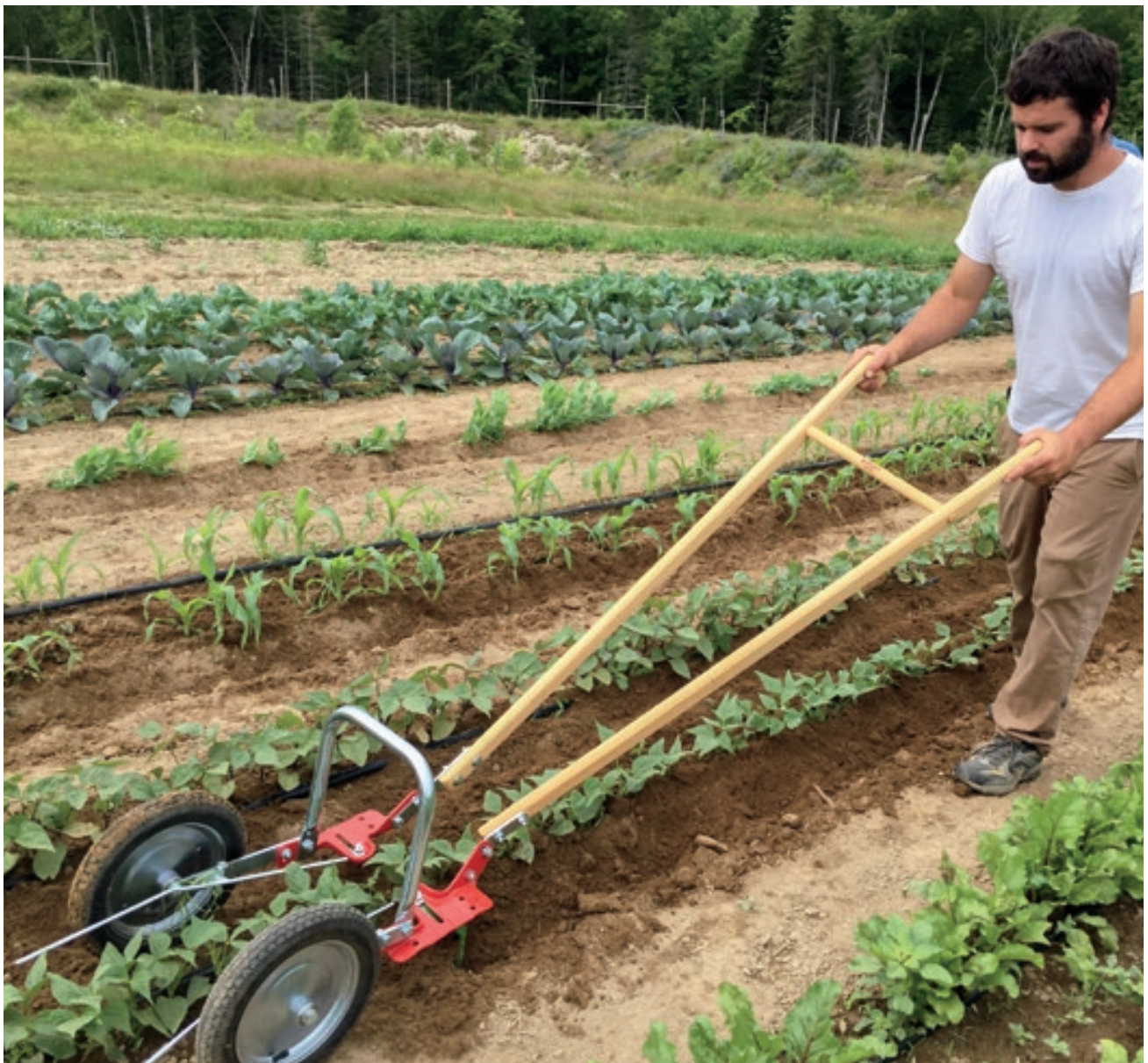
Doppelradhacke mit U-förmigem Bügel und Blattheber (Johnny's Selected Seeds)
